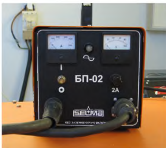
Рисунок 6 – Блок питания БП-02 подающего устройства ПДГО-601
