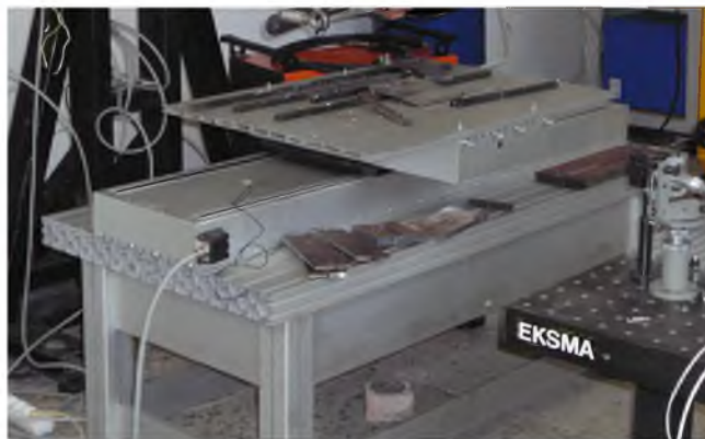
Рисунок 12 - Система перемещения заготовки относительно рабочего инструмента
