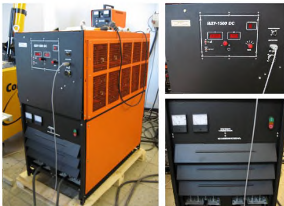
Рисунок 4 - Источник питания дуги ВДУ-1500 DC
