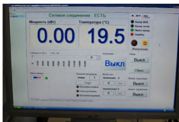
Рисунок 15 - Интерфейс системы, контролирующей состояние лазерного источника в процессе сварки
