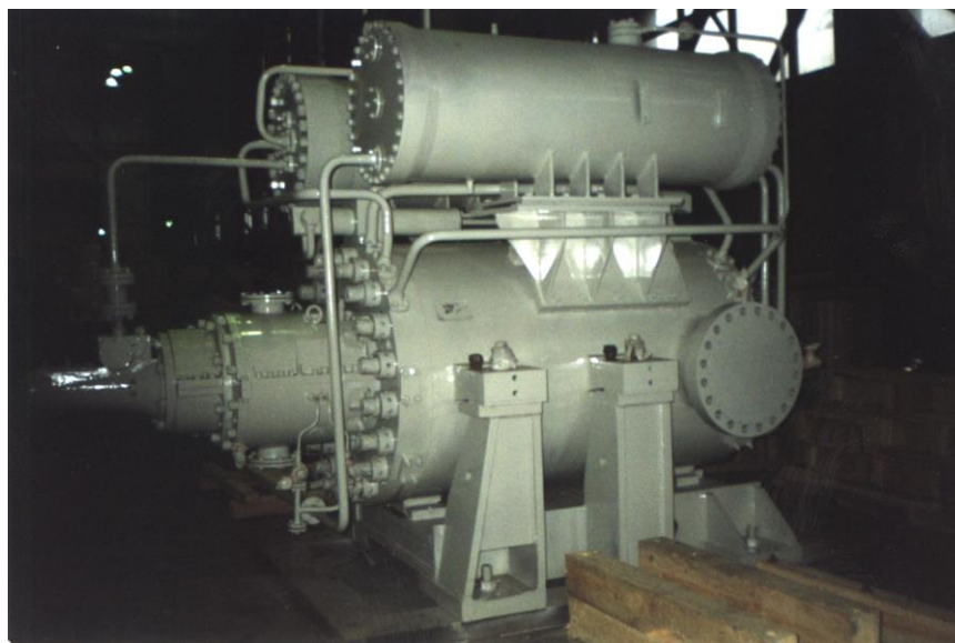
Рис. 1.3.16. Нагнетатель типа 108 для подземных хранилищ газа с конечным давлением 12,3 МПа. Сменные проточные части с 5 – 8 ступенями (ОАО «Компрессорный комплекс» по г/д проекту кафедры КВХТ СПбГПУ)
