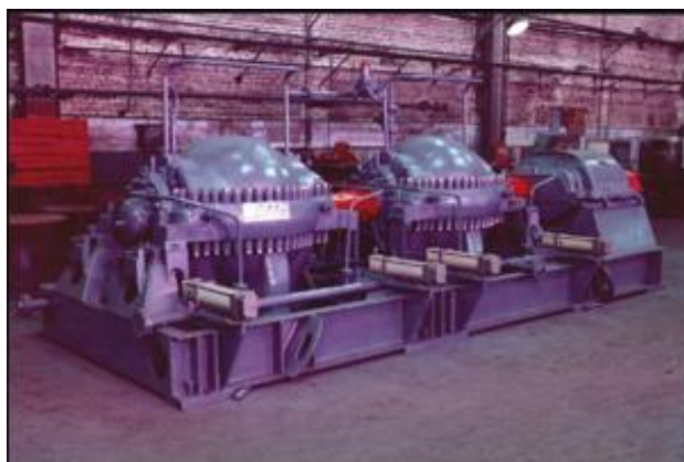
Рис. 1.3.13 а. Фреоновый холодильных агрегат АЦ44.2-2-5
