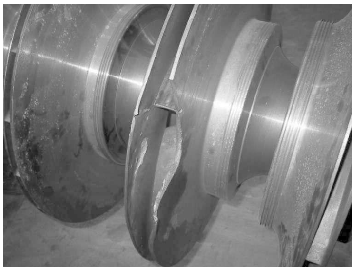
Рис. 7.1.3. Фото полотна диска разрушившегося после образования усталостных трещин
