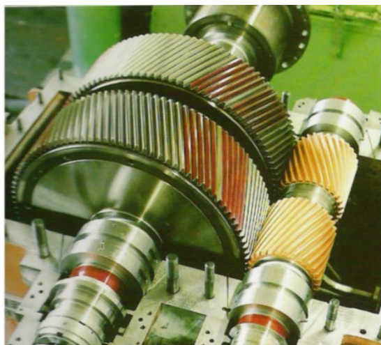
Рис. П.9.1. Слева – одноступенчатый мультипликатор с шевронным зацеплением (верхняя половина корпуса снята), справа – мультипликатор ряда центробежных компрессоров ZH 4000 – 7000 Atlas Copco
