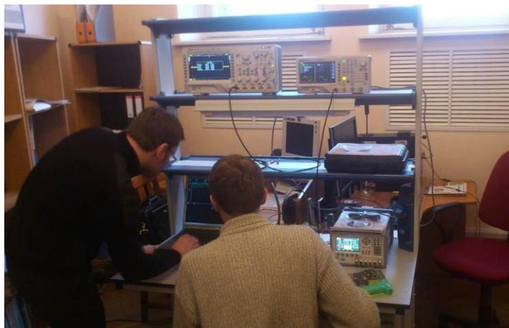
Рис. 23. Проведение работ по диагностике стационарного режима плазменного разряда в помещении ЛФУУПТ СПбГПУ.
