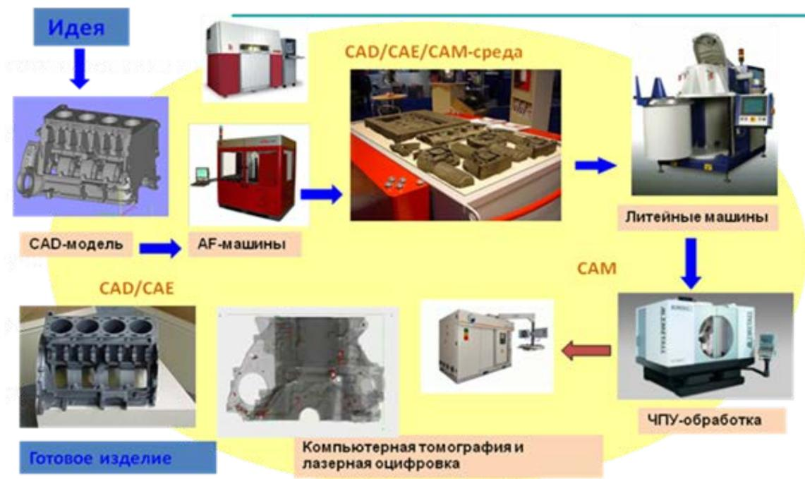
Рис. 48. Технологическая линейка НТК МашТех «Прототипирование и аддитивные технологии»
