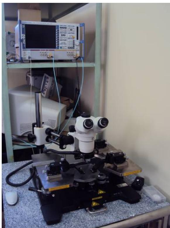
Рис. 59. Измерительный комплекс на базе зондовой станции Cascade Microtech EP6 и анализатора спектра Rohde @ Schwarz ZVA 40
