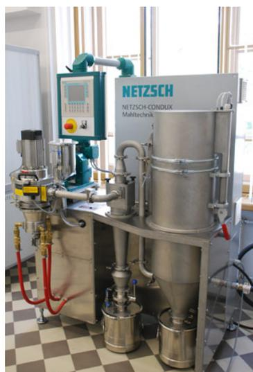
Рис. 47. Струйная мельница NETZSCH-CONDUX Mahltechnik GmbH
