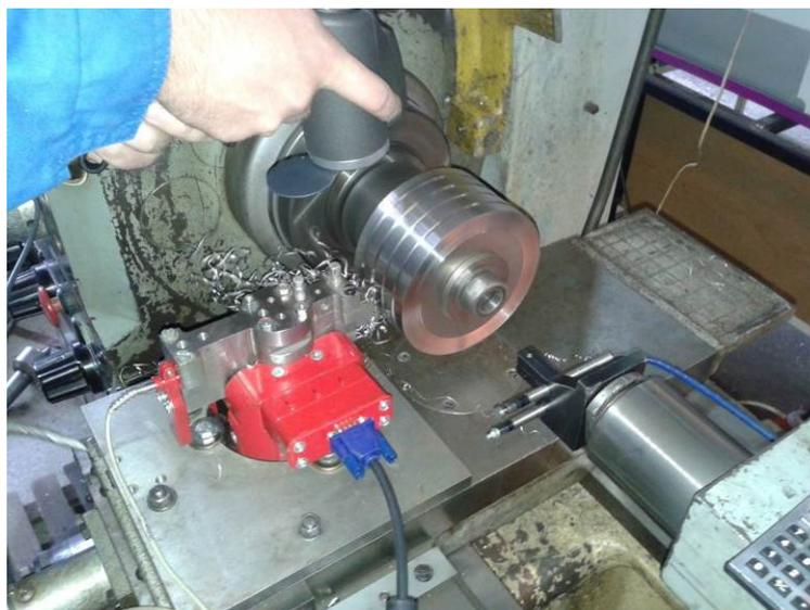
Рис. 58. Съемка температурного поля в процессе резания
