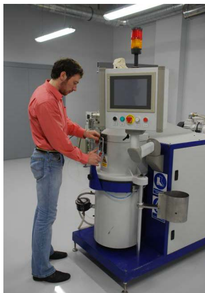
Рис. 6. IAC 300: Вакуумная литейная машина для литья сплавов цветных металлов
