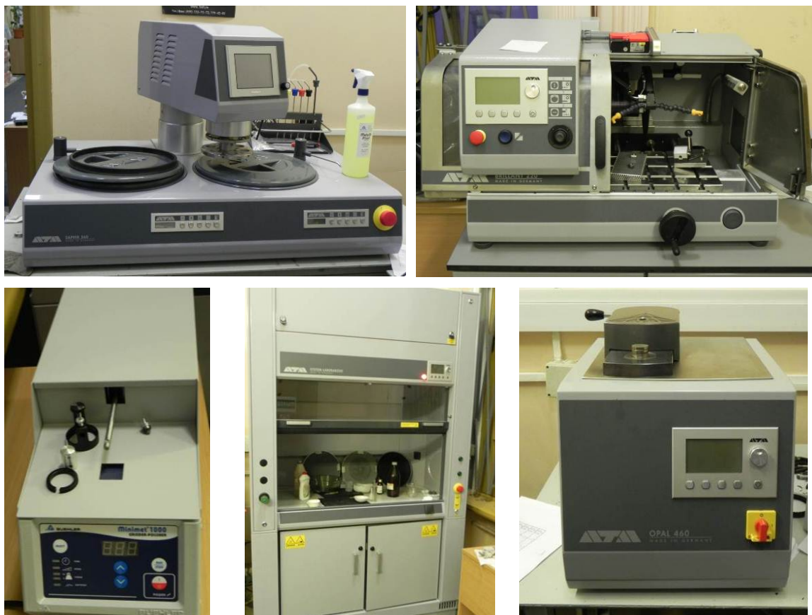
Рис. 86. Шлифоподготовительный комплекс: Шлифовально-полировальная машина «Saphir 560», Шлифовально-полировальная машина, для изготовления образцов для электронного микроскопа MiniMet 1000, Отрезная машина «Brillant 220.2», Пресс «Opal 460», Вытяжной шкаф «Laborabzug»
