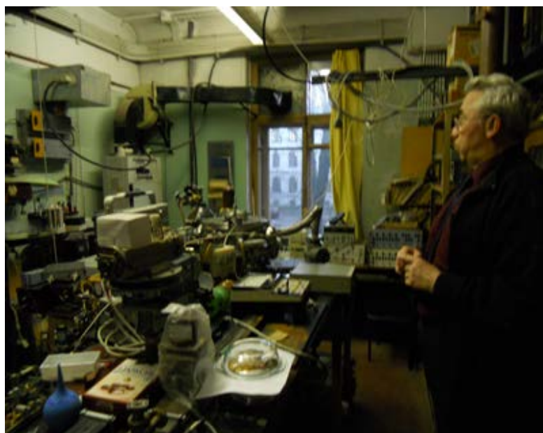
Рис. 39. Стенд для исследования свойств емкостного высокочастотного разряда для разработки технологии очистки диагностических и технологических зеркал во время разряда токамака
