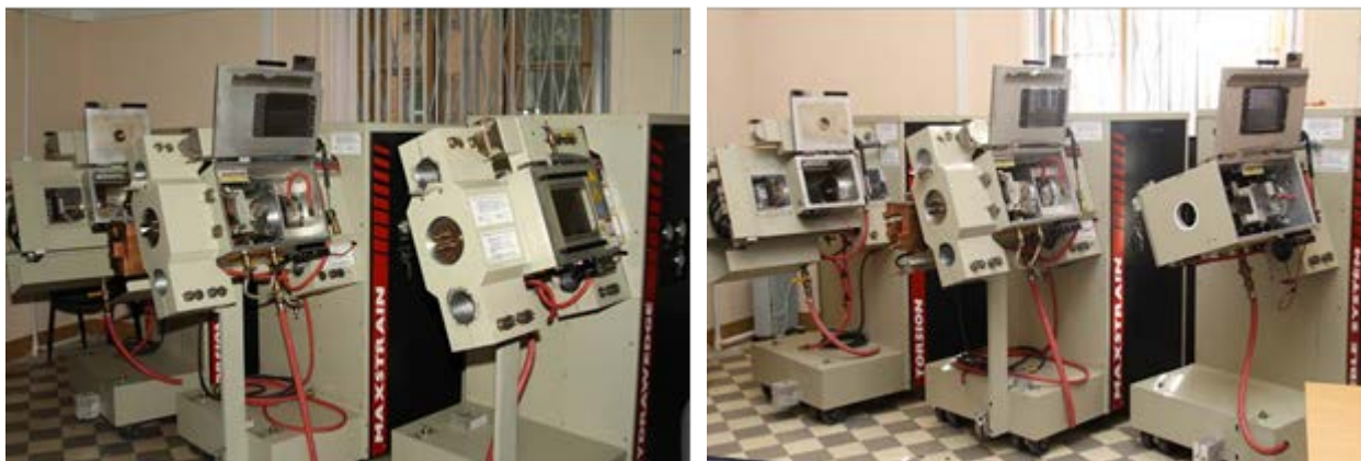
Рис. 7. Комплекс Gleeble-3800 – оборудование для исследования структуры и свойств материалов
