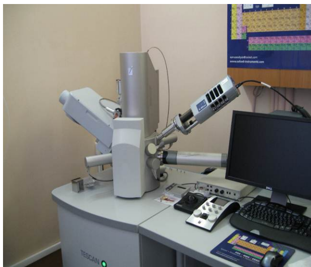
Рис. 8. Аналитический комплекс на базе сканирующего (растрового) электронного микроскопа Mira-3 «Tescan»
