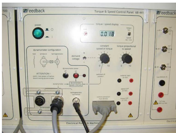
Рис. 70. Блок управления частотой вращения и тормозным моментом
