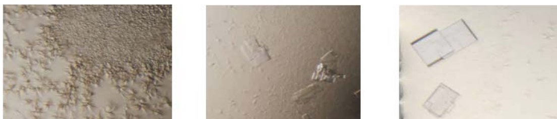
Рис. 41. Оптимизация кристаллов: первоначальный кристалл, кристалл после первого и второго шага оптимизации, после третьего шага оптимизации – кристалл годен для сбора дифракционных данных
