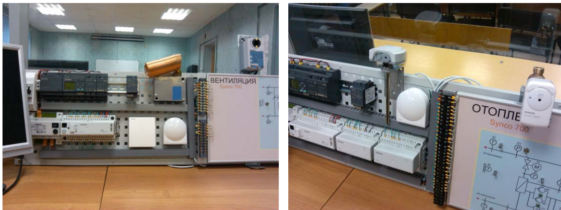
Рис. 84. Внешний вид лабораторных комплексов «Управление вентиляцией» и «Управление отоплением»
