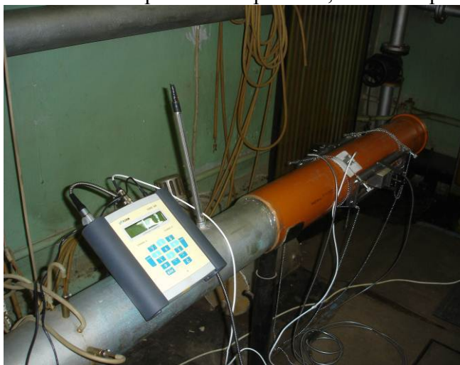
Рис. 77. Бесконтактный ультразвуковой расходомер FLUXUS ADM F601(слева), датчик бесконтактный ультразвукового расходомера FLUXUS ADM на экспериментальном стенде (справа)
