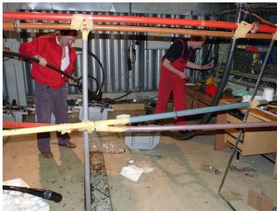
Рис. 34. Высоковольтная испытательная лаборатория TUK: испытание кабельных муфт «Пирелли»
