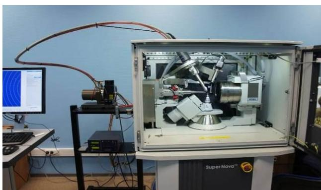
Рис. 36. Рентгеновская дифрактометрическая система SuperNova
