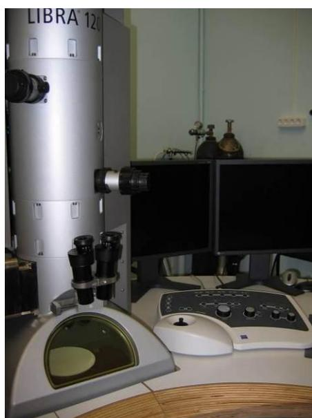
Рис. 39. Электронный микроскоп «LIBRA 120»
