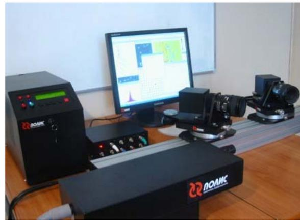
Рис. 6. Состав базовой системы 2D PIV «ПОЛИС»
