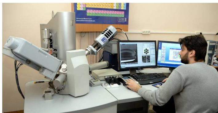
Рис. 2. Сканирующий микроскоп TESCAN «Mira-3»
