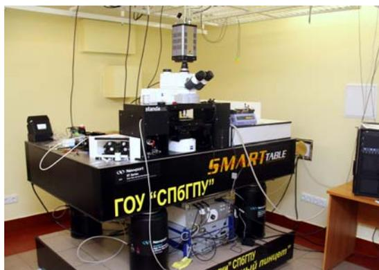
Рис. 10. Установка «Лазерный пинцет»
