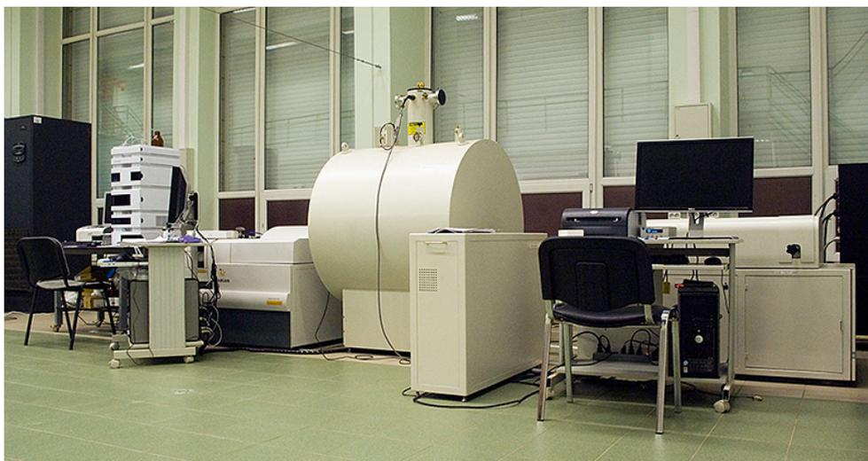
Рис. 8. Спектрометр ионно-циклотронного резонанса 9,4 Т Varian 903 – ICR FTMS
