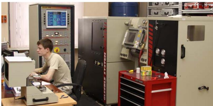
Рис. 4. Универсальный термомеханический комплекс Gleeble 3800
