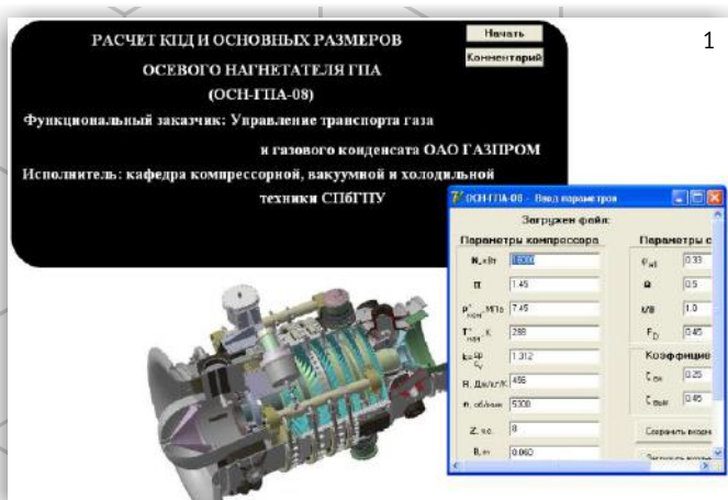
1. Заставка и меню ввода параметров программы ОСН-ГПА-08 для расчета КПД и основных размеров осевых компрессоров ГПА. Программа разработана по заданию ОАО «Газпром»; 2. Базовый компрессор для газоперекачивающих агрегатов серии НЦ-16 «Урал» с большой быстроходностью.
