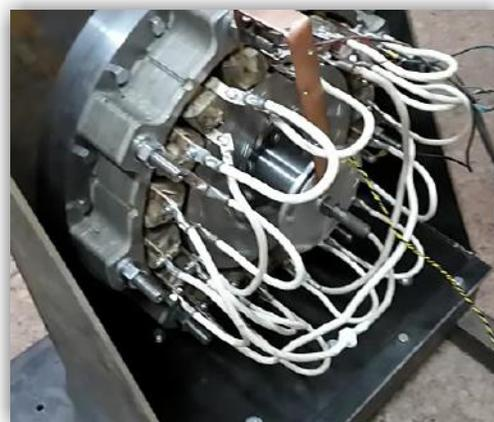
Экспериментальный образец верхнего электропривода
