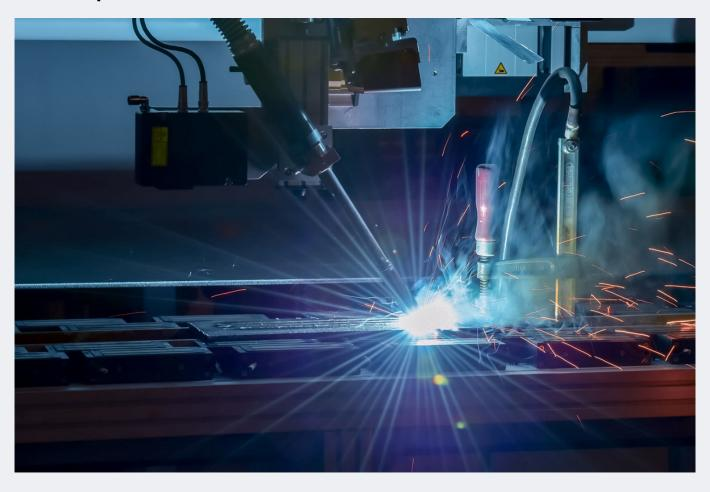
Инженеры Санкт-Петербургского политехнического университета Петра Великого разработали технологию электродугового выращивания, которая позволяет использовать металлическую проволоку вместо порошка для создания различных изделий. Данная технология способна значительно снизить стоимость аддитивного производства, а для изделий с простой геометрией конкурирует с токарно-фрезерным производством. Исследования ведутся в рамках нацпроекта «Наука».
