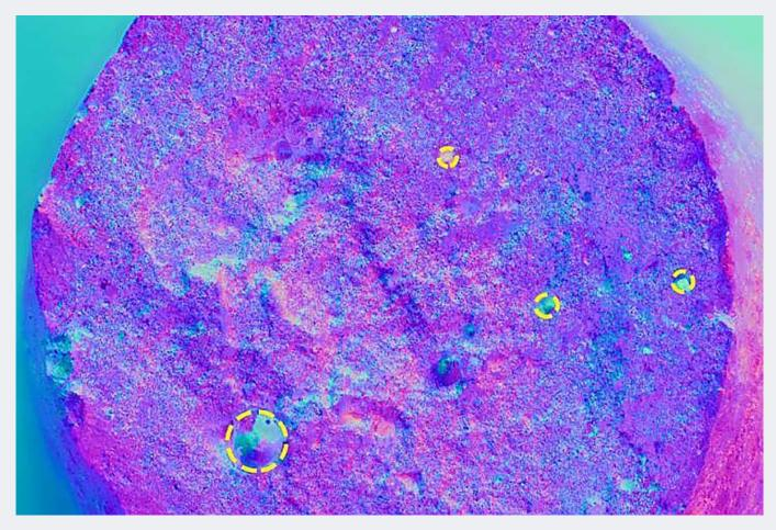
К улучшению пластических свойств алюминия привело увеличение скорости кристаллизации металла за счет повышения скорости электродугового выращивания до 2,2 кг/час. Изначально преследовалась утилитарная цель роста производительности, вызванная отсутствием на рынке специализированного оборудования для 3D-печати (электродугового выращивания).
