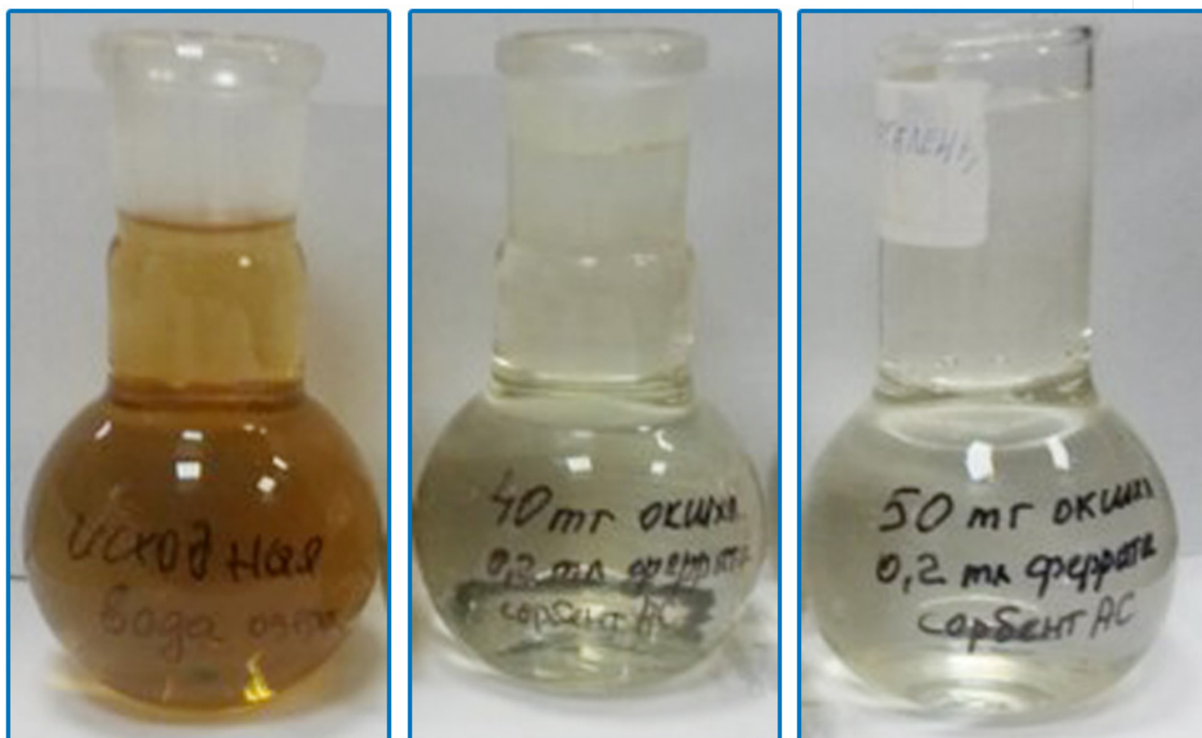
Феррат был опробован в качестве коагулянта для очистки воды искусственного водоема.
