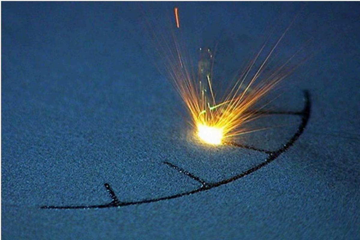
Ученые [REDACTED] и Делфтского технического университета (Нидерланды) разработали технологию получения новых структур металла методом селективного лазерного плавления (аддитивной технологии изготовления трехмерных объектов из металлических порошков). Основные результаты исследования представлены в журнале [REDACTED].
