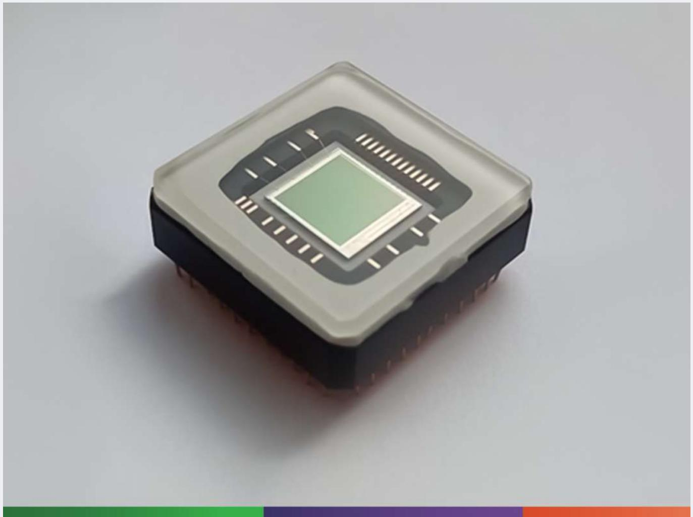
Специалисты Политеха приняли участие в разработке аналого-цифрового преобразователя (АЦП) для отечественного фотомодуля разрешением 4 мегапикселя.
