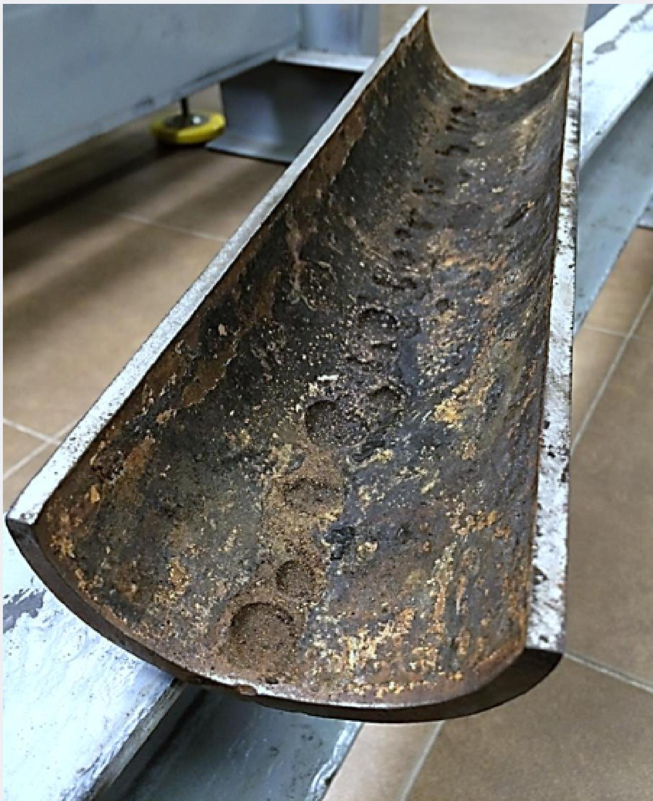
Разработанный в центре стенд позволяет проводить нестандартные испытания для экспресс-оценки металлов и покрытий к коррозионно-эрозионной стойкости в различных средах, с возможностью создания случаев чисто коррозионных потерь или чисто эрозионного износа, а также моделировать коррозионно-эрозионный случай. Использование экспериментальных методов моделирования процессов коррозии поможет разработать подходы для оценки новой коррозионностойкой стали для трубопромышленных условий.
